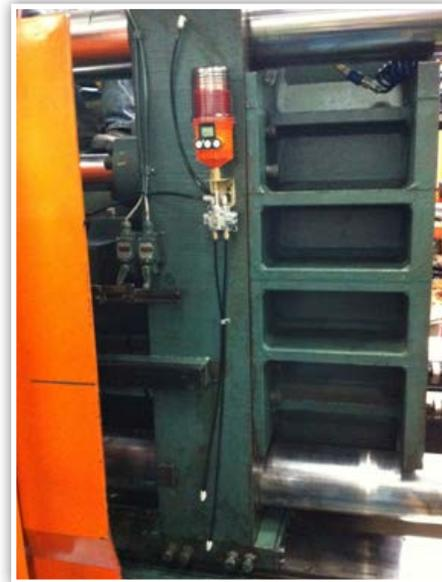
*El Streamliner M también se puede utilizar para lubricar puntos múltiples con el uso de un bloque de distribución progresivo. Para más información, favor de ponerse en contacto con su surtidor local o fabricante.*
